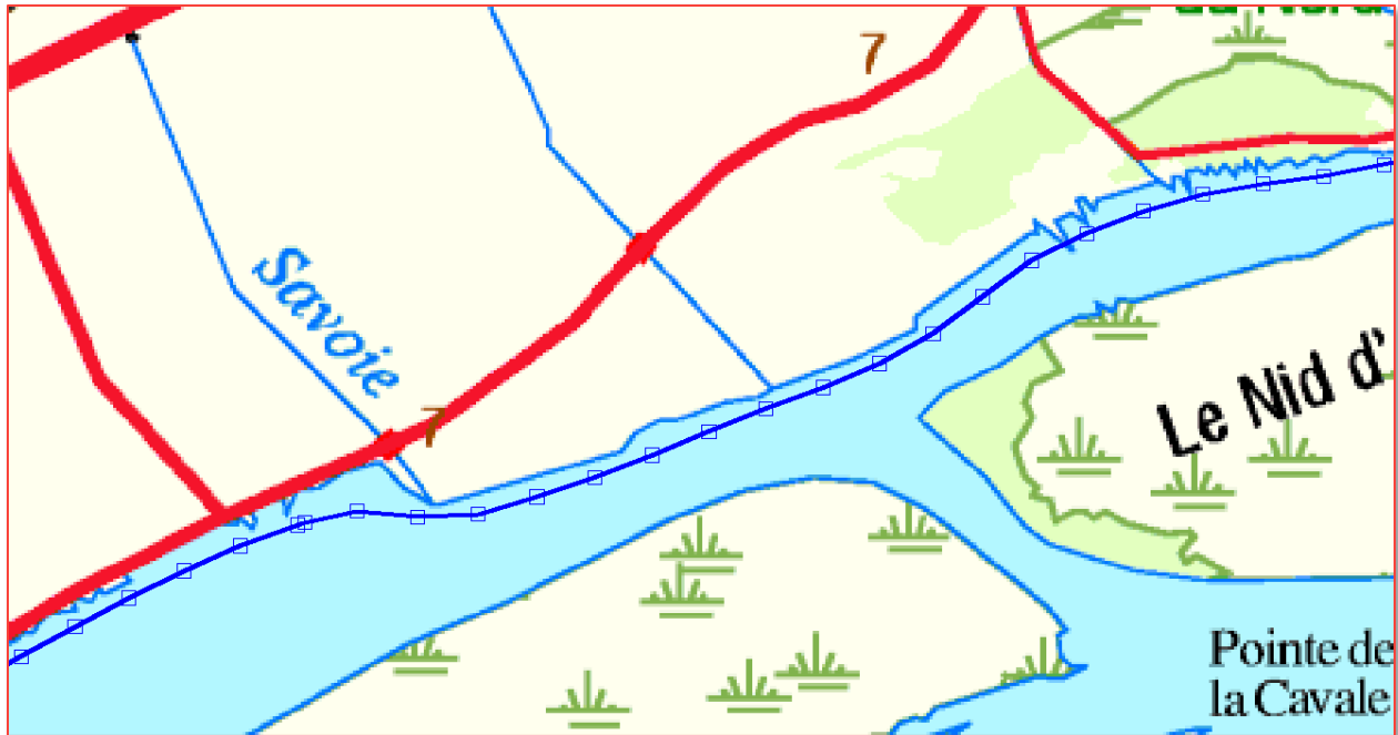
Figure 6-2 Points formant une partie du parcours Autray-01 desquels la cote de la surface de l'eau est extraite
