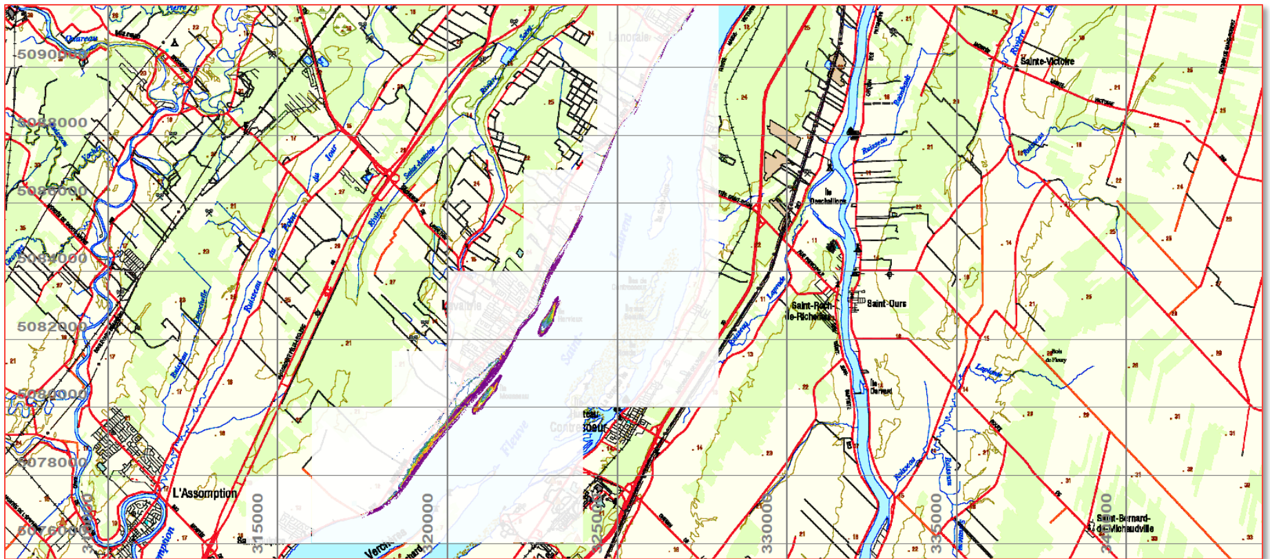
Figure 7-20 Zones inondées pour une crue de récurrence de 100 ans, région sud en transparence (à titre informatif)
