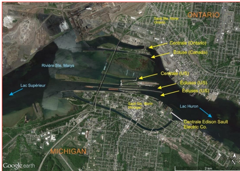
Figure 5-2 Configuration actuelle des ouvrages à la sortie du lac Supérieur
