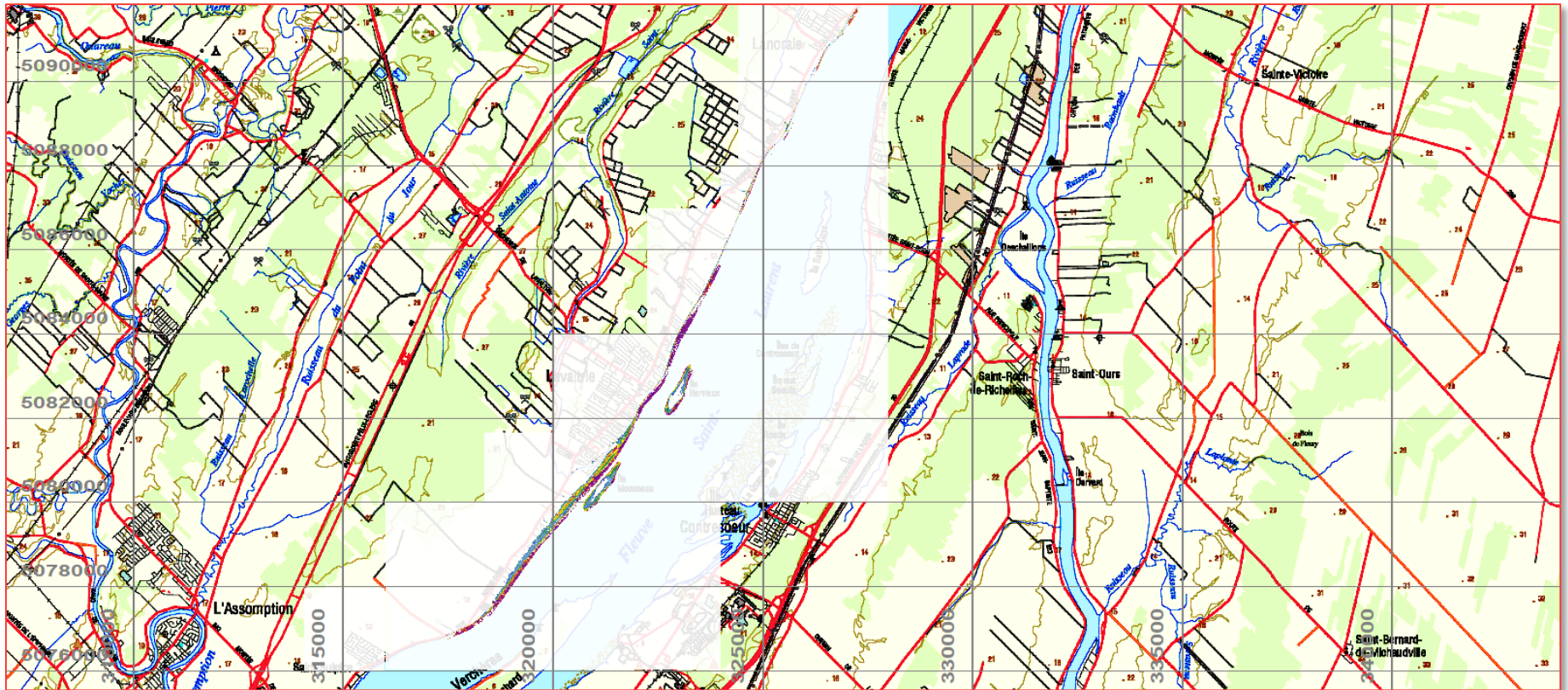
Figure 7-8 Zones inondées pour une crue de récurrence de 2 ans, région sud en transparence (à titre informatif)
