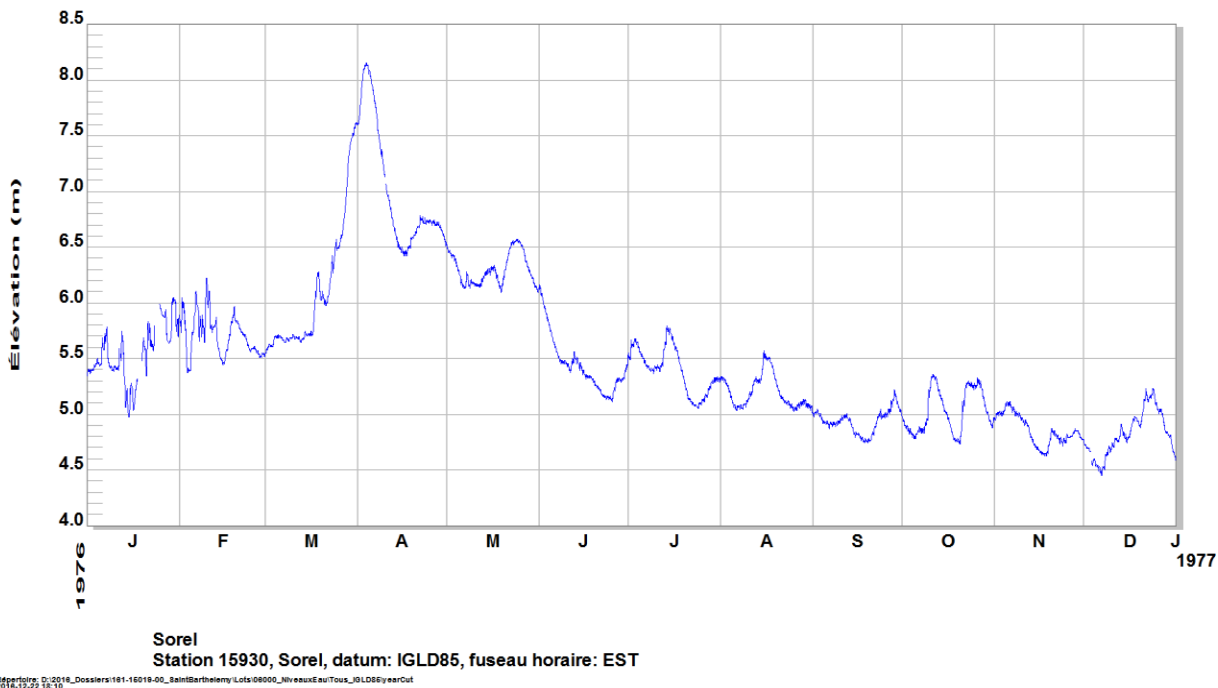
Figure 6-2 Niveaux d'eau mesurés à Sorel (IGLD85) lors de la crue de 1976
